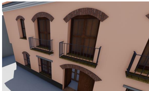
Fig. 113 Diferencia altura forjado y balcones. Fuente: realización propia, creación 05/07/2019
