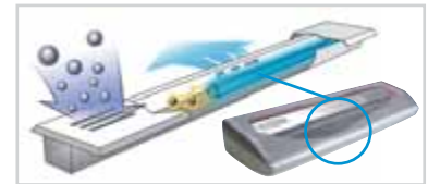
Unidad de esterilización de rayos ultravioletas.
