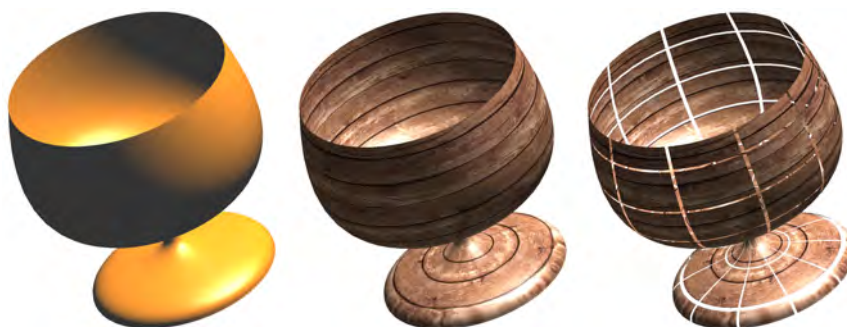
Figura 7.2: Ejemplo de combinación de textura 2D y textura procedural. A la izquierda el objeto es dibujado sin textura, en el centro se le ha aplicado una textura 2D, y a la derecha se ha combinado la textura 2D con una textura procedural
