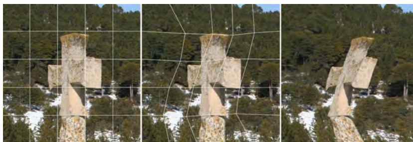
Figura 10.14: Warping de una imagen: imagen original en la izquierda, malla modificada en la imagen del centro y resultado en la imagen de la derecha
