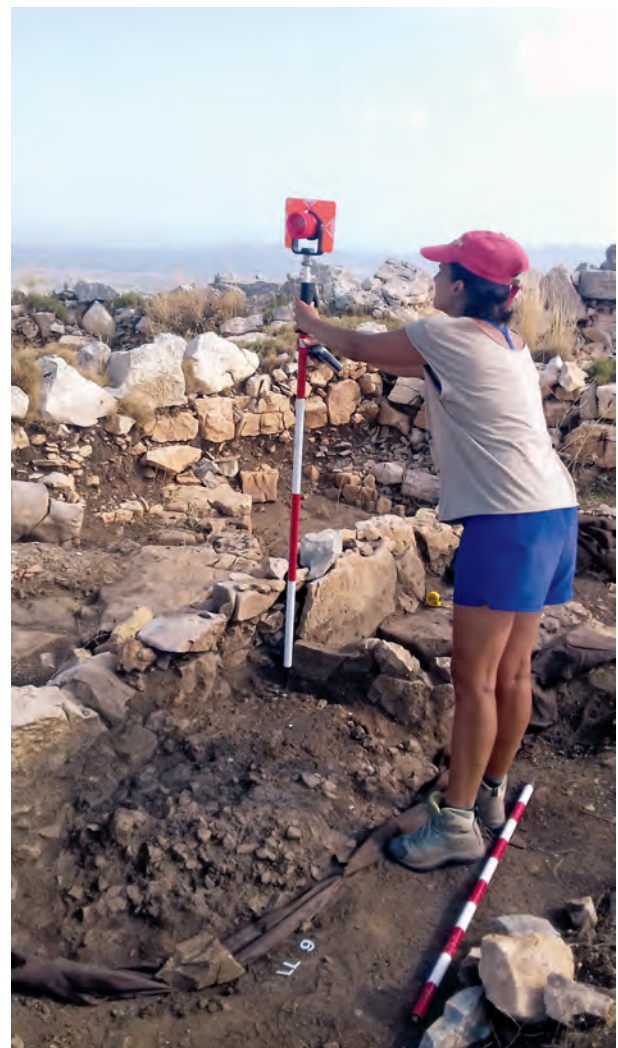
Figura 9. Localització de les mostres amb estació total.
