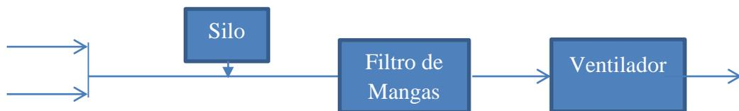
**Figura 6.4.** Diagrama de flujo del sistema de depuración.
