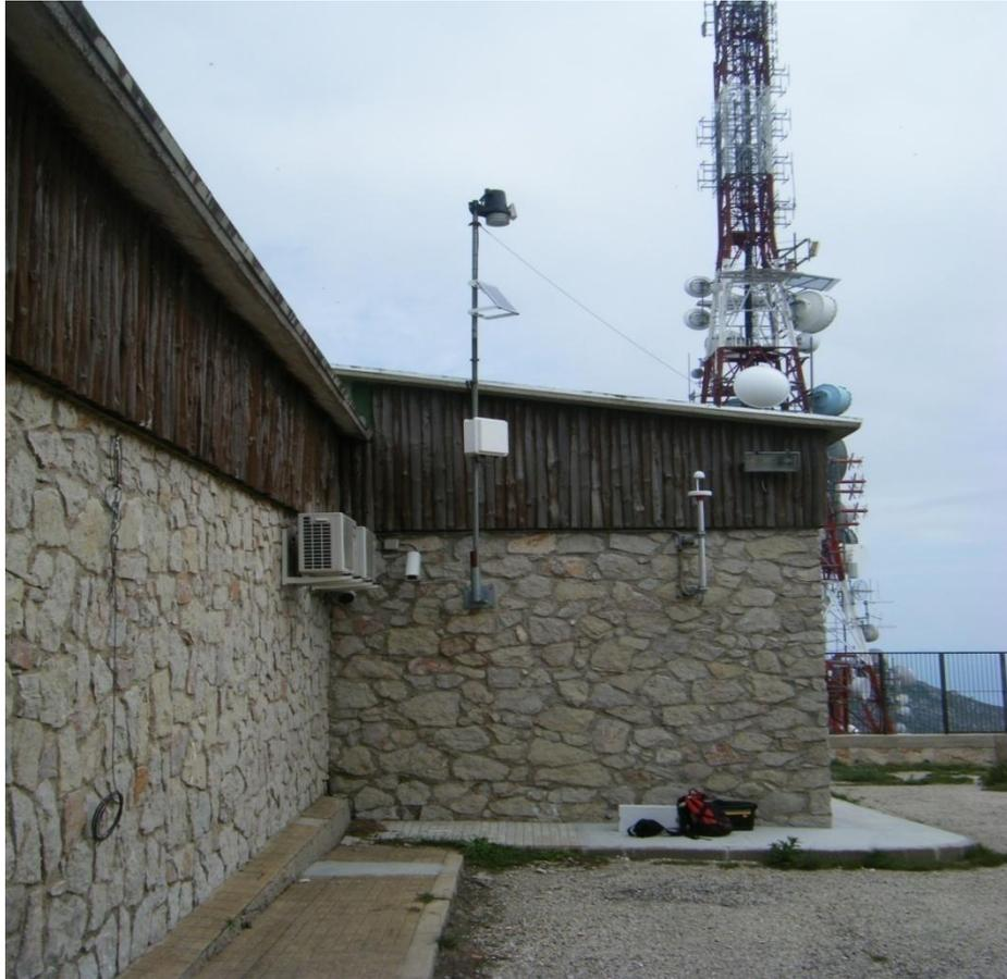
Figura 2: Estación meteorológica de la Universitat Jaume I en el monte Bartolo con el pluviómetro en su parte superior.
