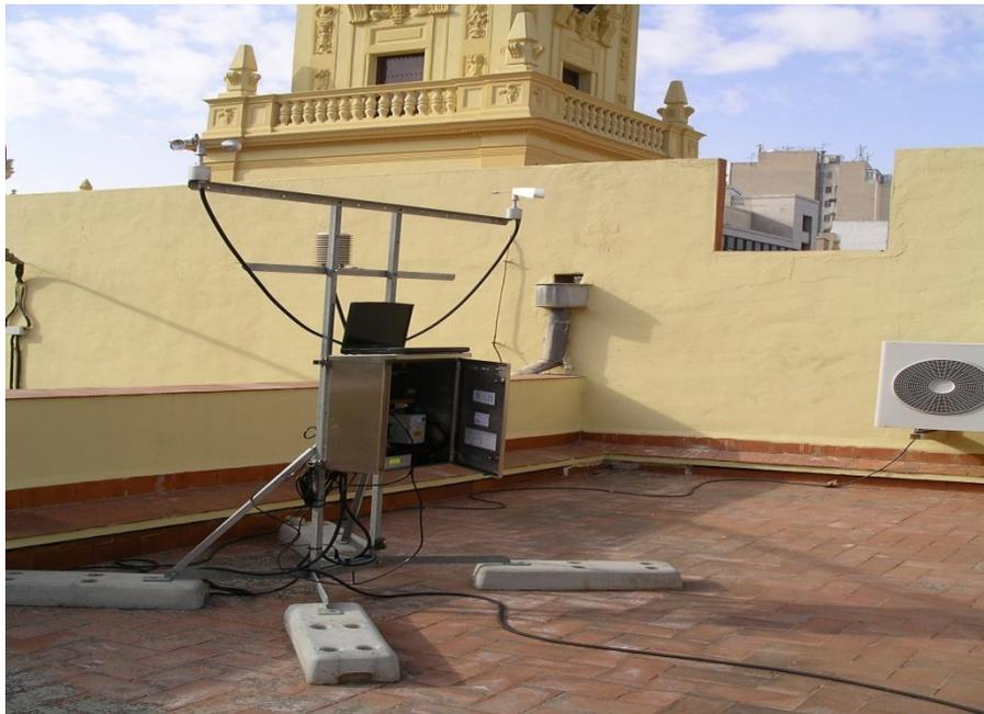
Figura 4: Estación meteorológica de la Universitat Jaume I en el Casino Antiguo de Castellón con los sensores de viento en sus extremos superiores.
