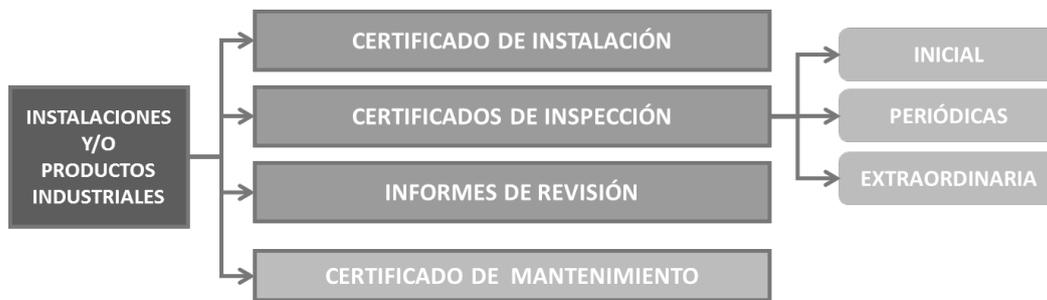
Figura 7.3. Mecanismos de inspección y validación de la seguridad.
