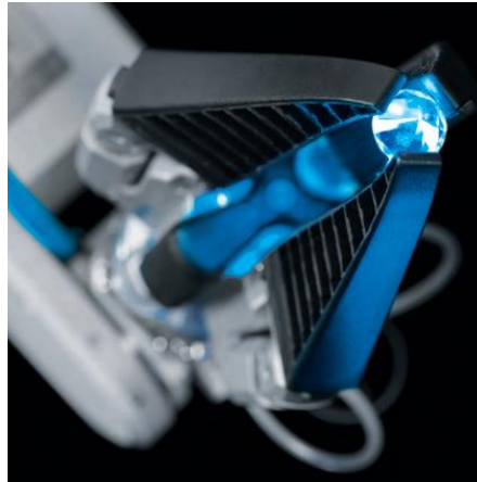
Ilustración 17. Configuración 3 dedos del FinGripper
