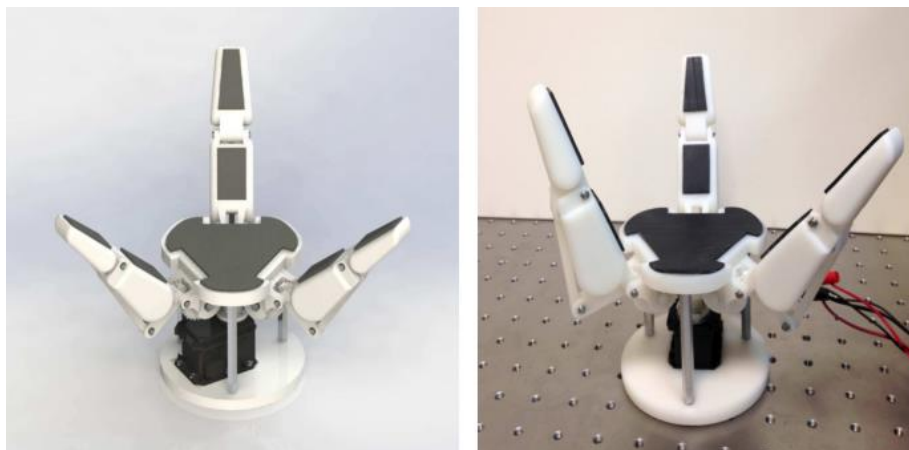
Ilustración 3. Garra en diseño virtual (izq.) y prototipo en 3D (der.)
