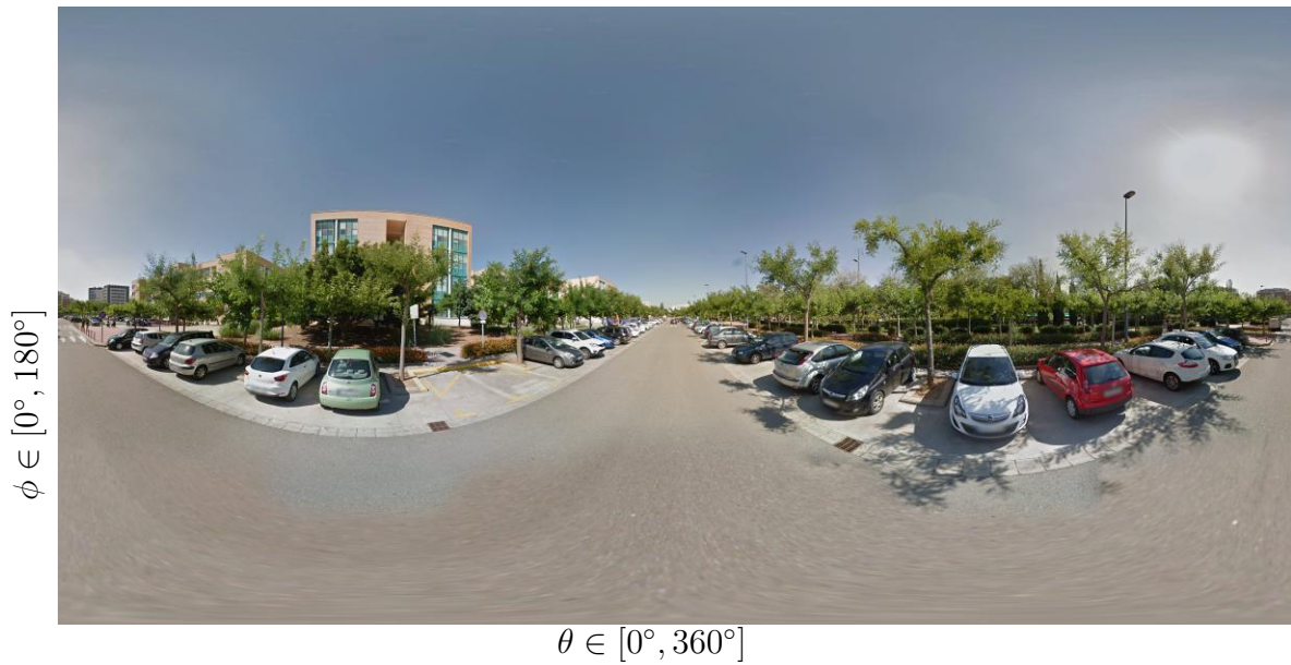
Figura 3.2: Vista panorámica. Muestra la imagen esférica completa sobre un plano, de tal modo que cada coordenada representa un ángulo ( \theta y \phi ), que conjuntamente identifican un punto de la esfera en coordenadas polares (Fuente: Google Street View [2]).
