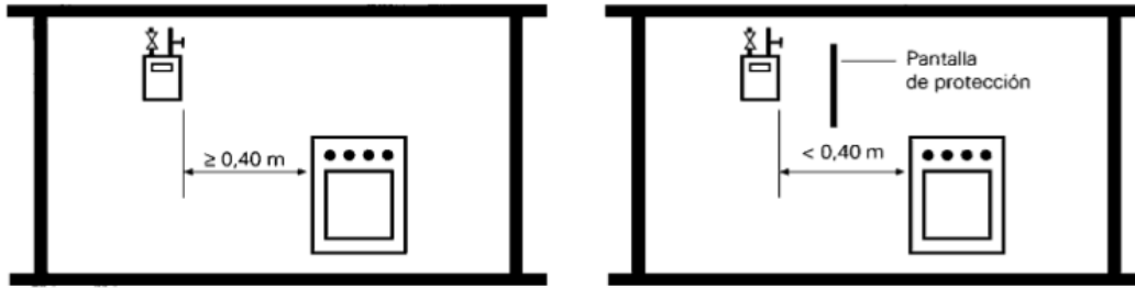
Ilustración 8. Separación mínima de los contadores.
