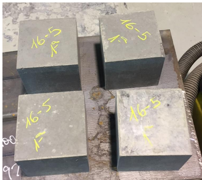
Imagen 5.2. Probetas cúbicas 100mmx100mmx100mm.
