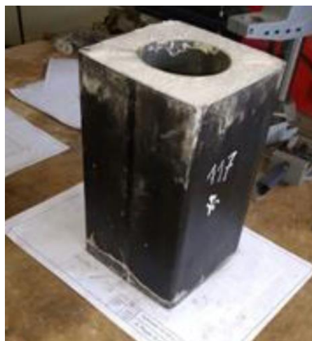
Imagen 5.12. Marcado de los pilares a ensayar.
