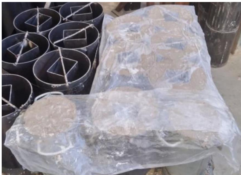
Imagen 5.5. Plástico empleado para evitar variaciones en la humedad.
