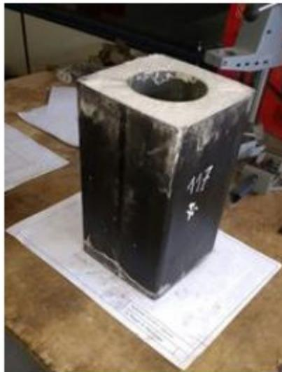
*Ilustración 71: Ejemplo gráfico de pilar CFDSST elaborado por el grupo de estructuras mixtas de la UJI*
