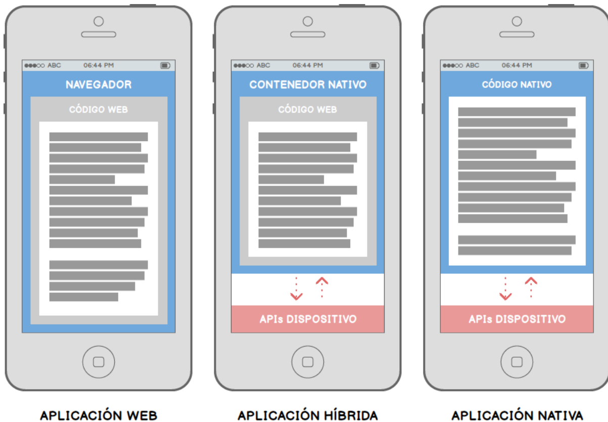
Figura 2.1: Los tres tipos de aplicaciones móviles de hoy en día: (1) la aplicación web accedida a través de un navegador, (2) la aplicación híbrida ejecutada en un contenedor y traducida a nativa y (3) la aplicación nativa directamente ejecutada en el dispositivo. Fuente: adaptación propia de [12]
