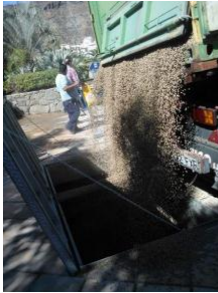
Descàrrega a granel de biomassa
