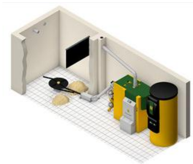
Sòl horitzontal en emmagatzemament de biomassa. Font: Catàleg KWB
