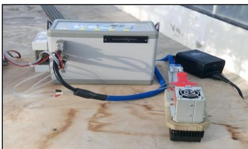
**Figura 6.** Analizador de gases Lcpro+.
