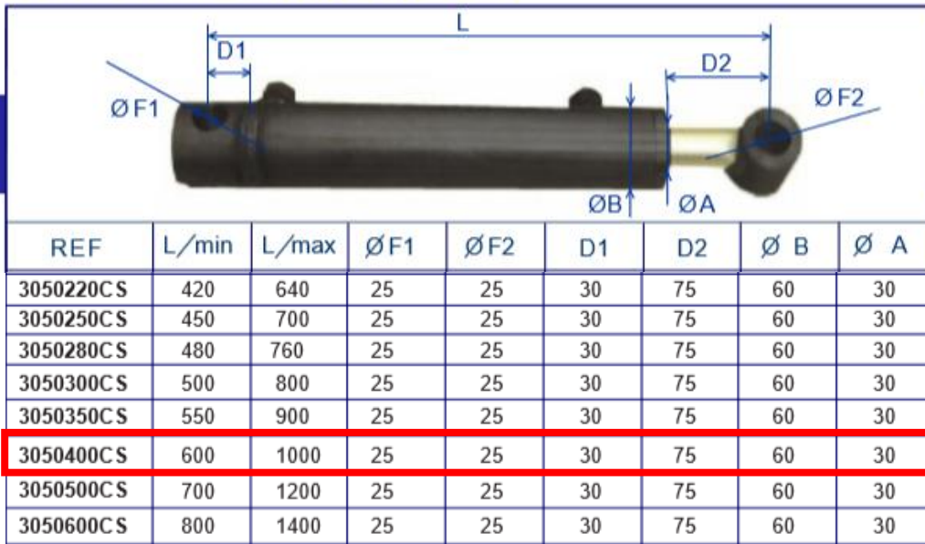
Figura A31. Características dimensionales pistón hidráulico.
