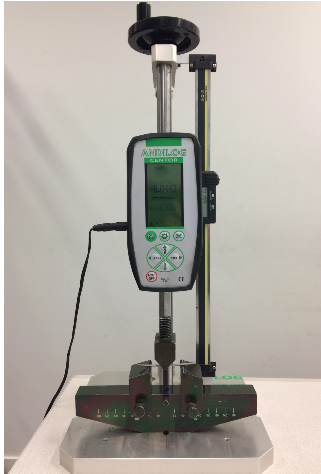
Figura 1.30. Vista general del ensayo mecánico experimental de flexión en 3 puntos
