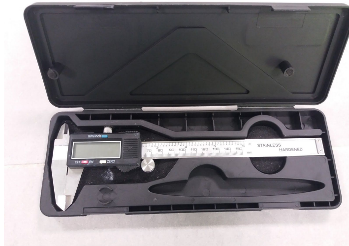
Figura 4.1.1.4. Pie de rey digital empleado para las mediciones de longitud del microtubo.
