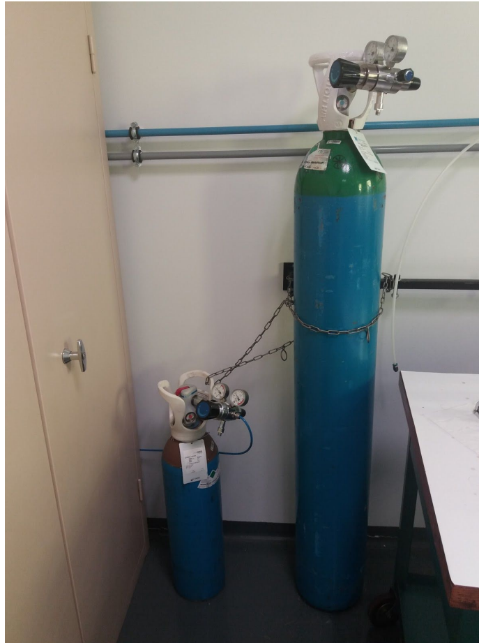
Figura 4.1.4.2. De izquierda a derecha, depósito de helio y de argón empleados durante las prácticas.
