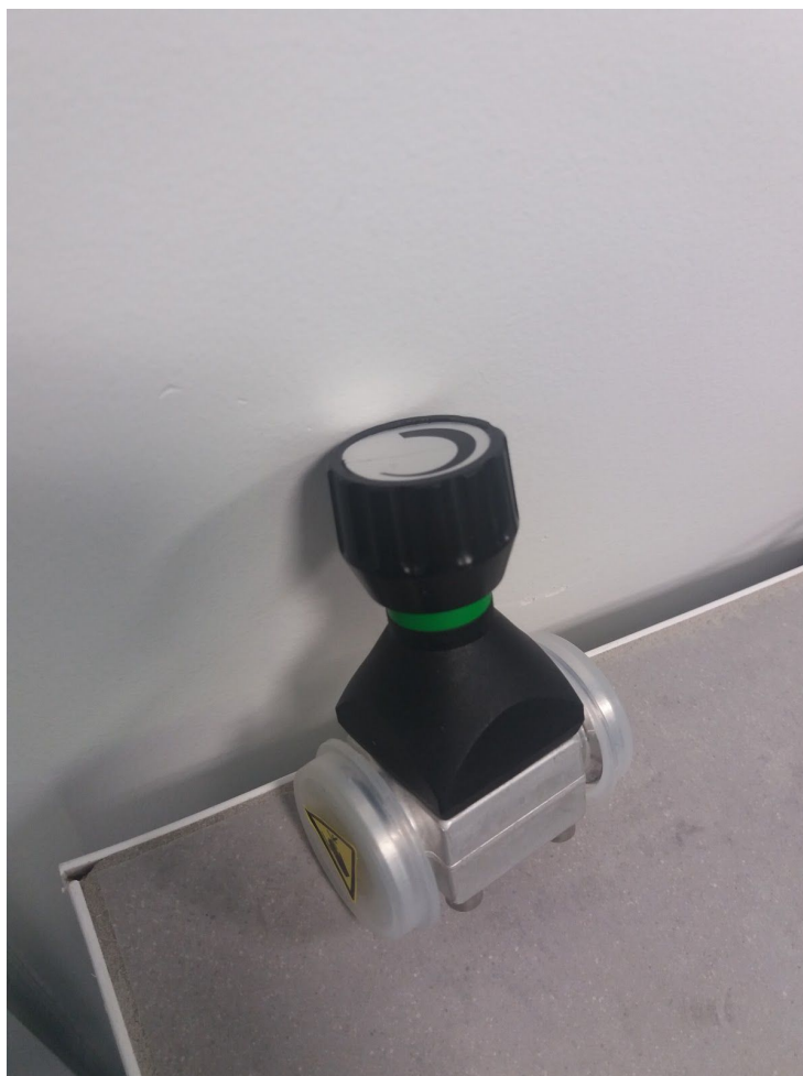
Figura 4.1.2.1. Vista exterior de la válvula de diafragma.
