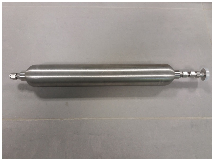
Figura 6.2.2. Volumen extra insertado en la zona fría.
