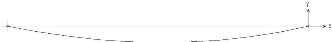
Imagen 51. Deformada de la viga carril en el plano XY.
