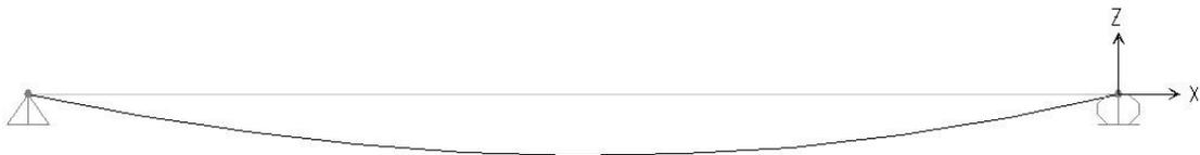
Imagen 45. Deformada de la viga carril en el plano XZ.
