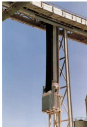
Figura 29. Sistema de contrapeso por gravedad.
