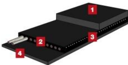
Figura 15. Partes de una banda con cable de acero.
