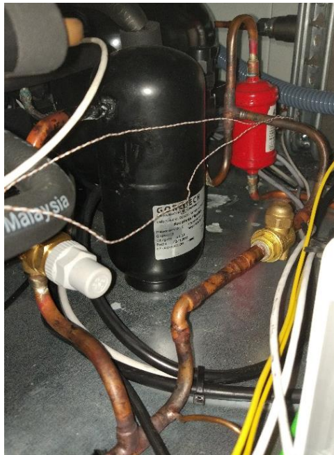
Figura 35. By-pass al depósito.
