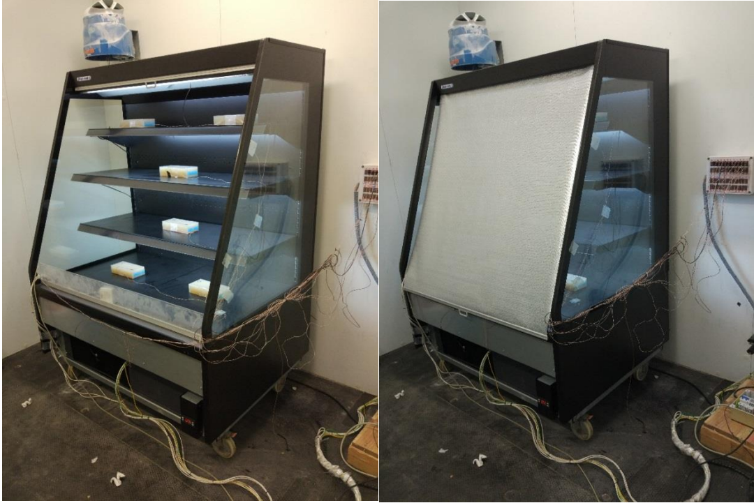
Figura 29. Mueble frigorífico sin tapa nocturna (dcha.) y con tapa nocturna (izq.).
