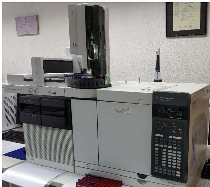
Figura 18. Imagen del equipo GC-QqQ empleado para el análisis de rutina.
