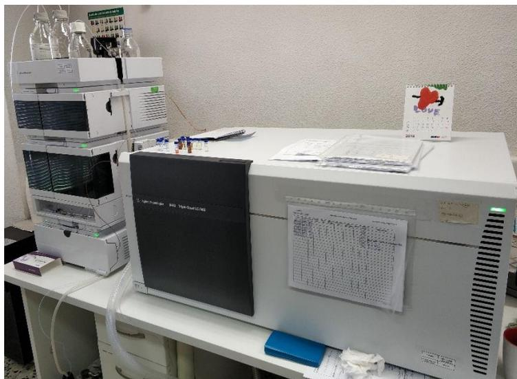
**Figura 17.** Imagen del equipo HPLC-QqQ empleado para el análisis de rutina.
