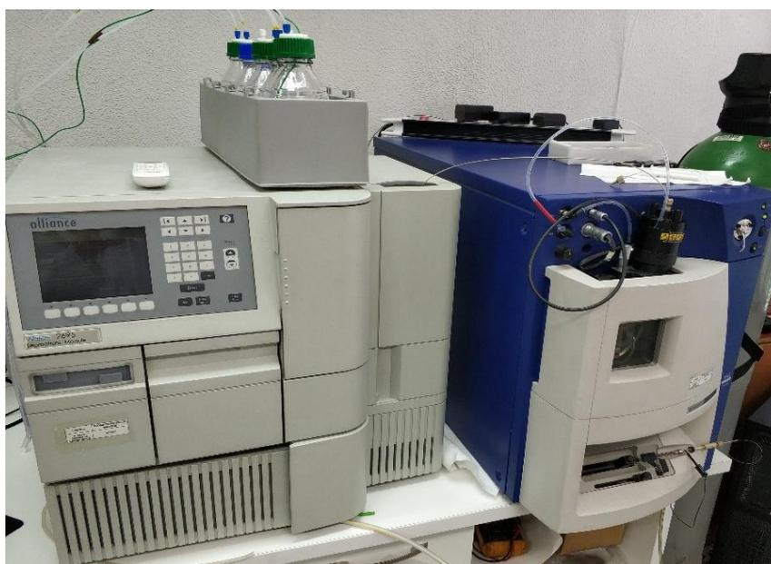
**Figura 21.** Imagen del equipo HPLC-QqQ empleado para el diseño y validación de los métodos.
