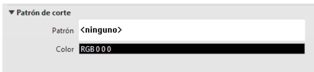
Si quiero cambiar el grafismo de un material, entro en la ventana de materiales, selecciono LH7, por ejemplo. Y selecciono **Patrón de corte**. Cambiará la forma en que este material se verá seccionado.
