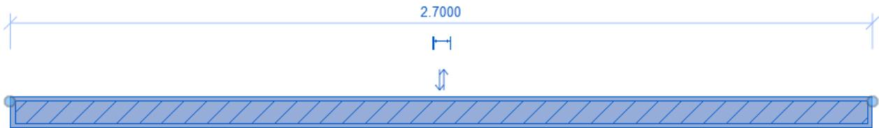
Una vez colocado, si queremos cambiar la cara de las capas que conforman el muro, clicando las flechas o apretando la tecla Espacio, se invierten las capas internas del muro. Para modificar varios elementos a la vez emplear la tecla Espacio únicamente.
