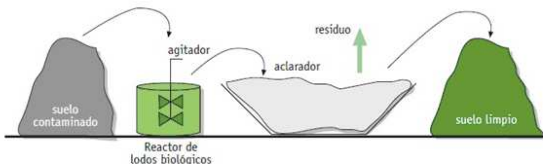
Figura 16: Tratamiento mediante lodos biológicos. Fuente: Ortiz et al., (2007)
