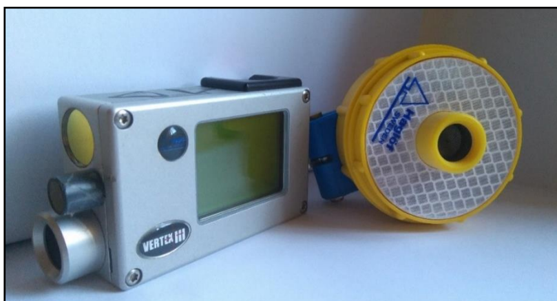
Figura 3.1: Hipsòmetre i reflector. Font: Cristina Albert
