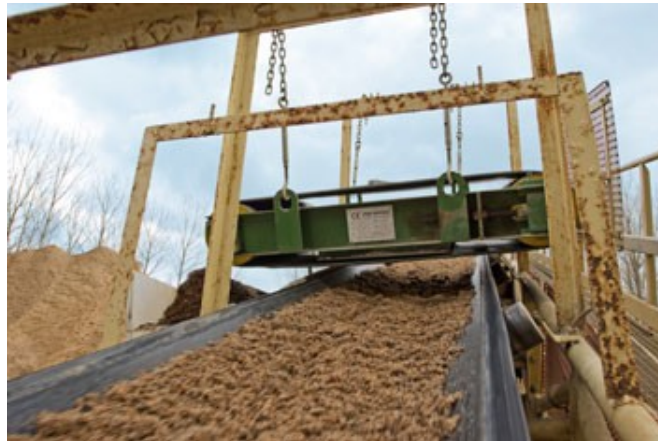
Imagen 7: Imán para eliminar metales y proteger equipos de procesamiento de tierra.
