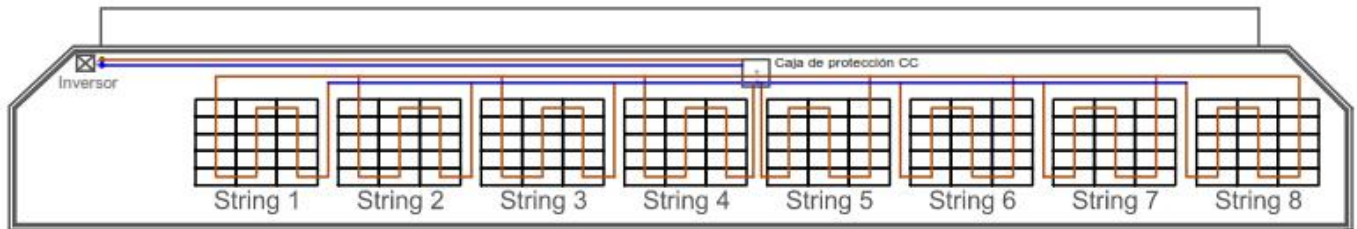
Imagen 32. Croquis del cableado de la parte de corriente continua de la instalación.
