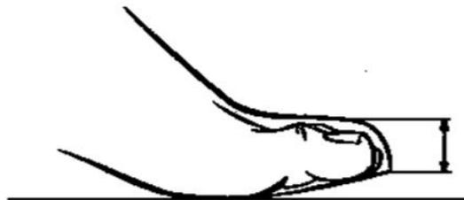
Imagen 73. Espesor de la puntera
