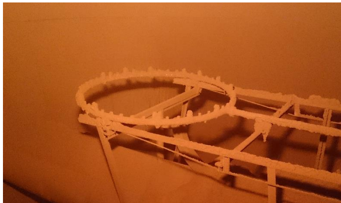
Figura 7.3: Sistema de nebulización por corona.
