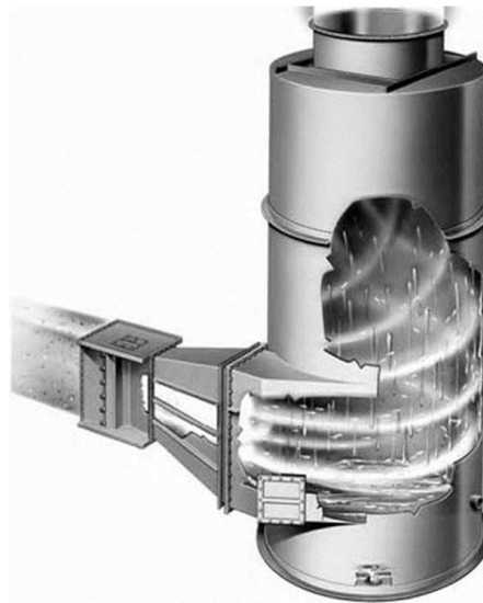
Figura 8.2: Separador en húmedo tipo Venturi.
