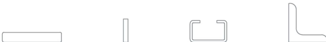
*ilustración 52; pistas de deslizamiento*
