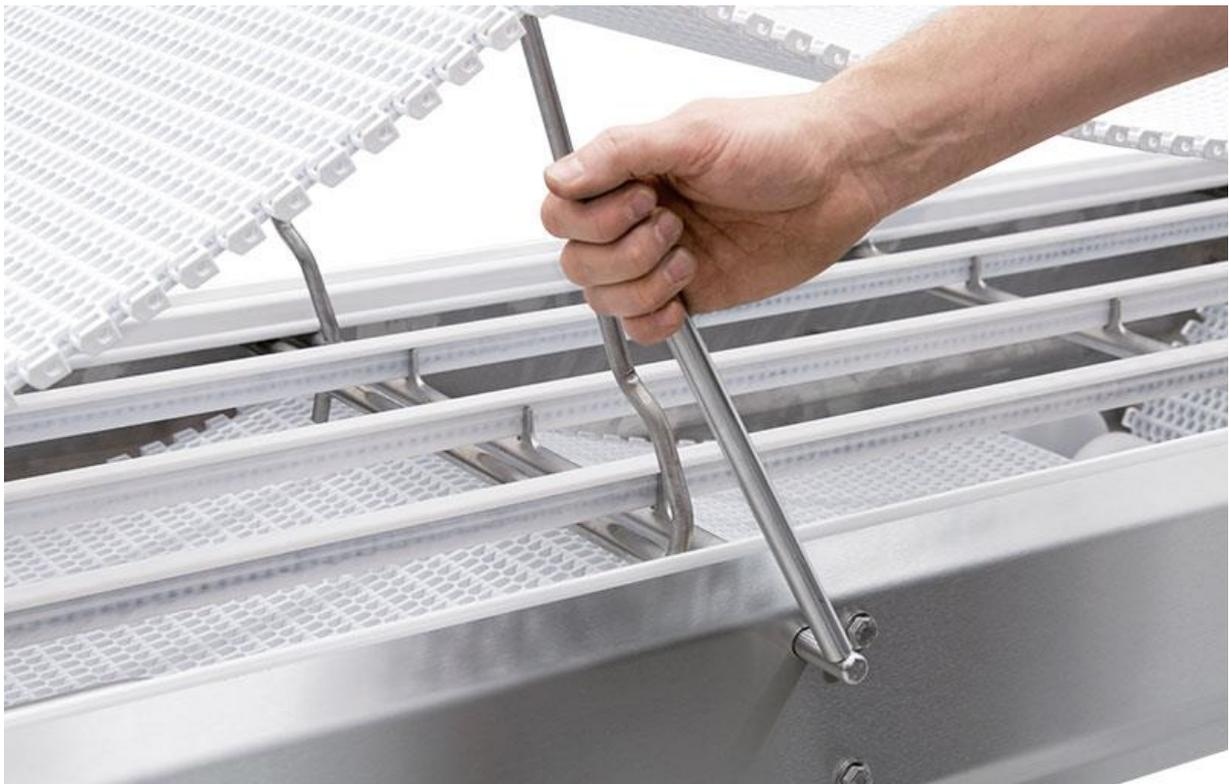
*ilustración 54; acceso a los perfiles para mantenimiento*
