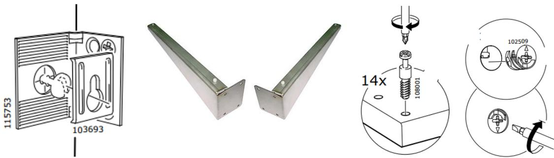
M.22. Fijación a pared    M.23. Escuadras de sujeción    M.24. Perno y Excéntrica K12
