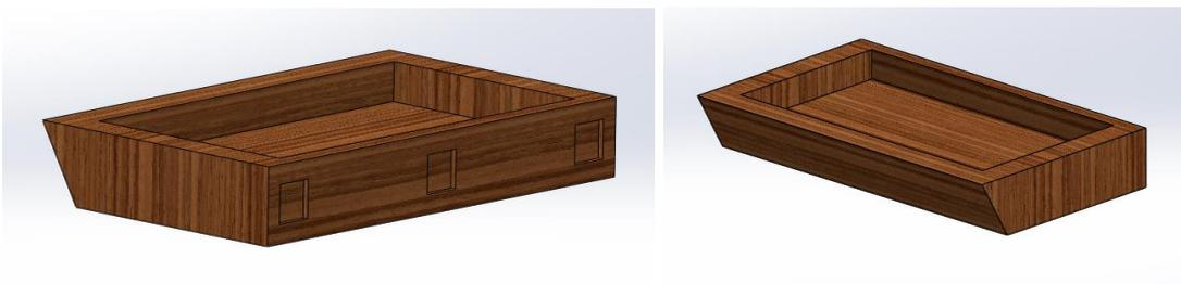
PC.4. Vistas del estante de madera y sus fresados en planta y cara posterior.
