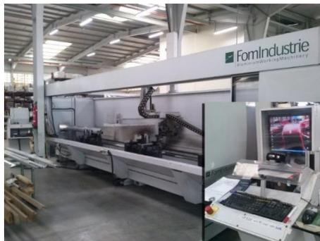
Figura 20. Centro longitudinal de mecanizado para perfiles.
