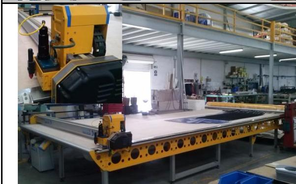
**Máquina:** Plotter de corte CN.
