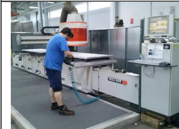
**Máquina:** Centro mecanizado CN. Centro destinado a madera adaptado a espuma de poliuretano y resinas por la similitud de la dureza del material. Esta máquina trabaja sobre superficies y volúmenes.
