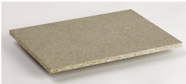
Figura 13. Detalle panel de madera aglomerado partículas.
