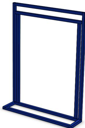
Figura 2. Estructura para el módulo puerta corredera.
