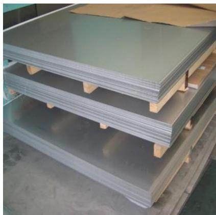
Figura 5. Detalle Chapa AISI 304.
