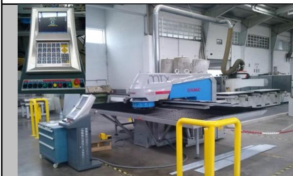
**Máquina:** Punzonadora CN. Posee portaherramientas con 12 punzones distintos su mesa de trabajo abarca chapas de más de 2 metros de ancho por alto.
