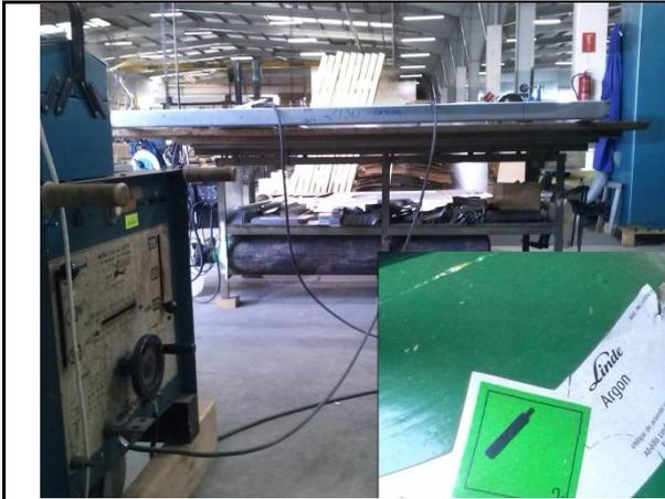
**Máquina:** soldadora por arco, TIG. Como gas inerte, el Argón.
