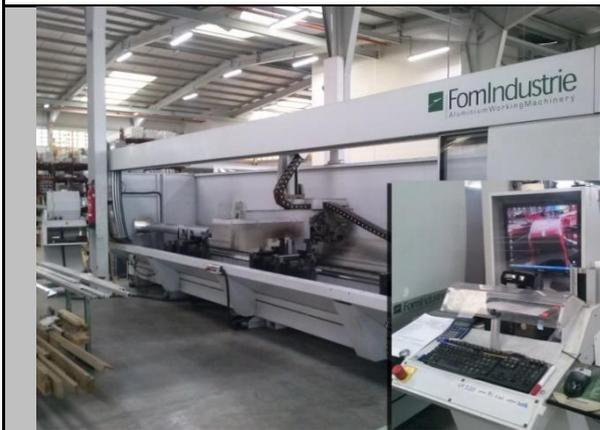
**Máquina:** Centro mecanizado CN. Centro destinado a Aluminio y Aceros. Trabaja sobre perfiles longitudinales.
