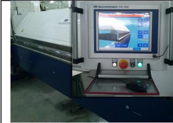
**Máquina:** Dobladora-Paneladora CN
