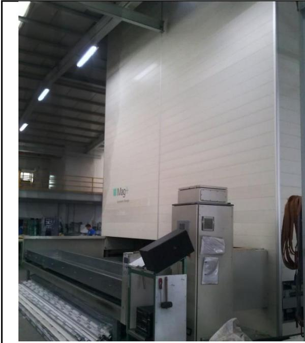
**Máquina:** Almacén vertical automático. Cajones que de manera vertical se almacenan y un sistema de cadenas y railes acceden a ellos de forma automática controlada desde el cuadro de mandos.
