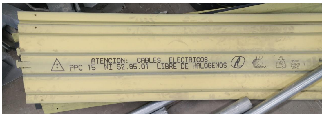
Imagen 30. Ejemplo de cinta de señalización de conductores eléctricos
