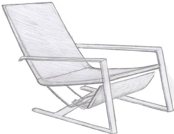
Se trata de un sillón reclinable, donde el mecanismo se ejecuta de forma manual: es un mecanismo sencillo de barras, en el cual, el movimiento del respaldo va unido al del reposapiés. Estos se mueven al mismo tiempo. El sillón es de madera maciza y sus componentes y barras también. Para realizar el movimiento de bisagra y horizontal de las barras es necesario algún mecanismo disponible en el mercado.
