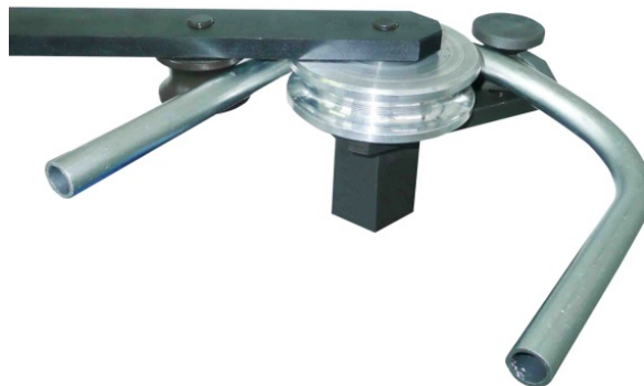
Imagen 9. Detalle matriz y mordaza máquina curvado mediante brazo giratorio
