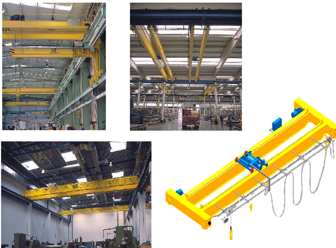
Figura 27. Puente grúa. Fuente: Catálogo GH
