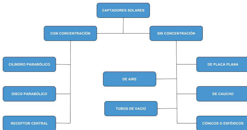
Figura 4. Esquema clasificación de captadores
