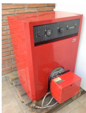
Figura 16. Clasificación de calderas. Caldera convencional de gasoil.
