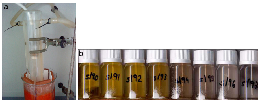
Figura 1 – (a) Montaje preparado para determinar cinéticas por fotodegradación y (b) evolución de la intensidad del color de una disolución de Naranja II en función del tiempo de irradiación.
