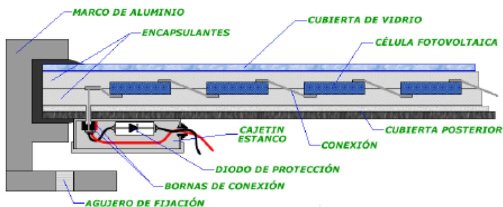
Figura 3: Corte transversal de un módulo fotovoltaico
