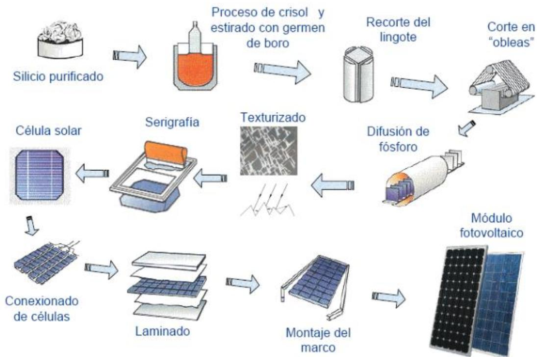
Figura 4: Fabricación de los módulos fotovoltaicos
