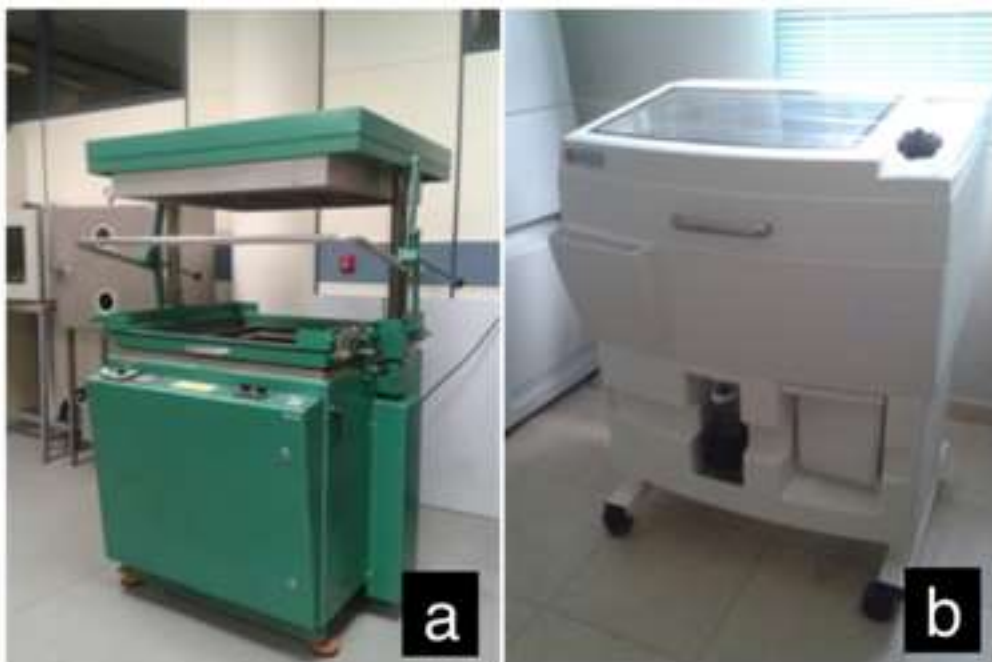
Figura 6. Equipos de conformado utilizados: a) Máquina termoconformadora; b) Equipo de fabricación aditiva mediante tecnología 3DP, modelo Zprinter 310 plus de ZCorporation
