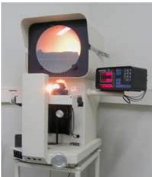
Figura 5. Medición, mediante proyector de perfiles, de las geometrías de los moldes
