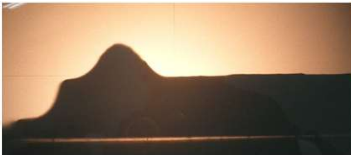
Figura 19. Perfiles termoconformados de las Piezas 2.1 y 2.2. Se puede apreciar la menor resolución geométrica de la lámina termoconformada respecto el molde original realizado en 3DP
