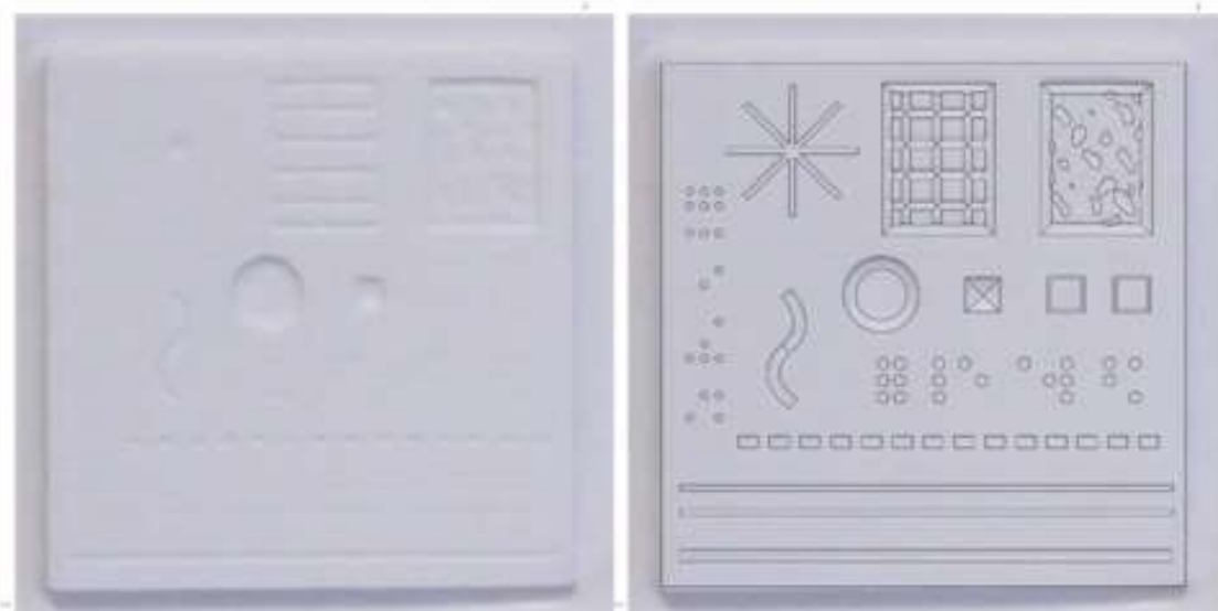
Figura 18. Imagen del termoconformado sobre molde en negativo (izquierda), y su superposición fotográfica con la geometría teórica diseñada (derecha). Se aprecia una menor reproducción de los detalles
