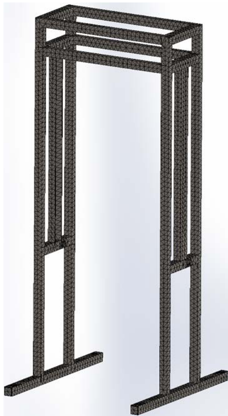
Figura 98. Características de la malla en Solidworks
