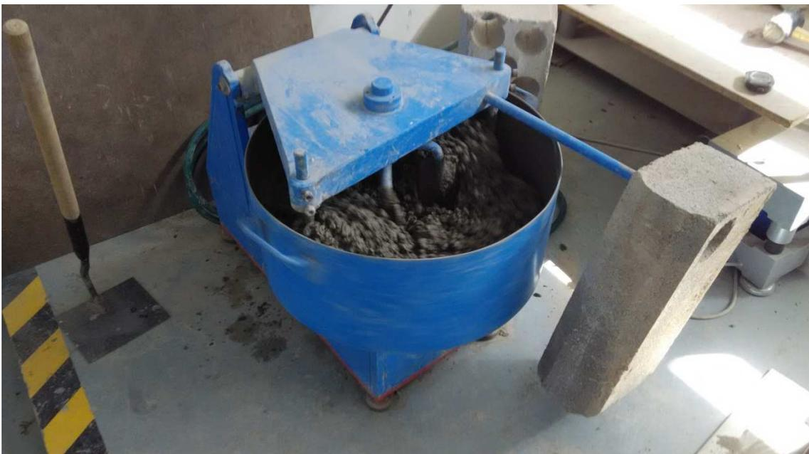
Figura 36. Amasado de hormigón en hormigonera de 30 L
