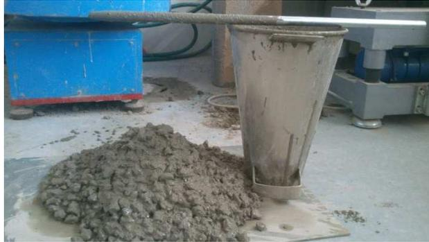
Figura 14. Ensayo de asiento del hormigón medido en cono Abrams
