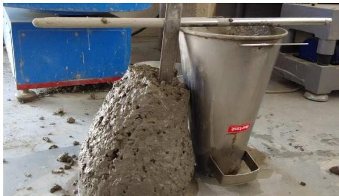
Figura 16. Ensayo de asiento del hormigón en laboratorio
