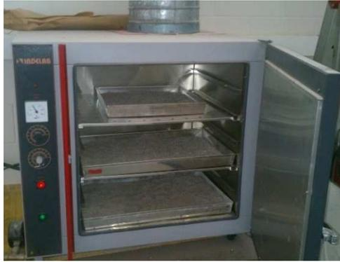
Figura 33. Secado arena lavada (0/4) en estufa a  $100 \pm 5^\circ\text{C}$
