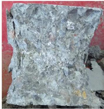
Figura 19. Probeta resultante tras limpieza de lajas
