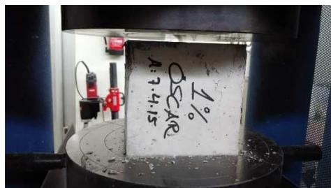
Figura 15. Ensayo a compresión sobre probeta cúbica
