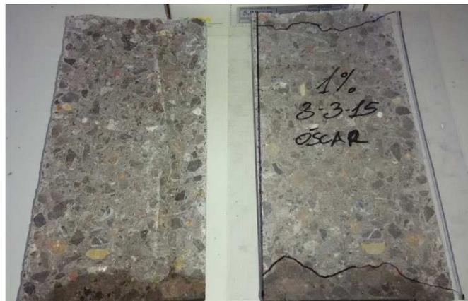
Figura 5. Probeta cilíndrica ensayada a tracción indirecta, tras penetración de agua
