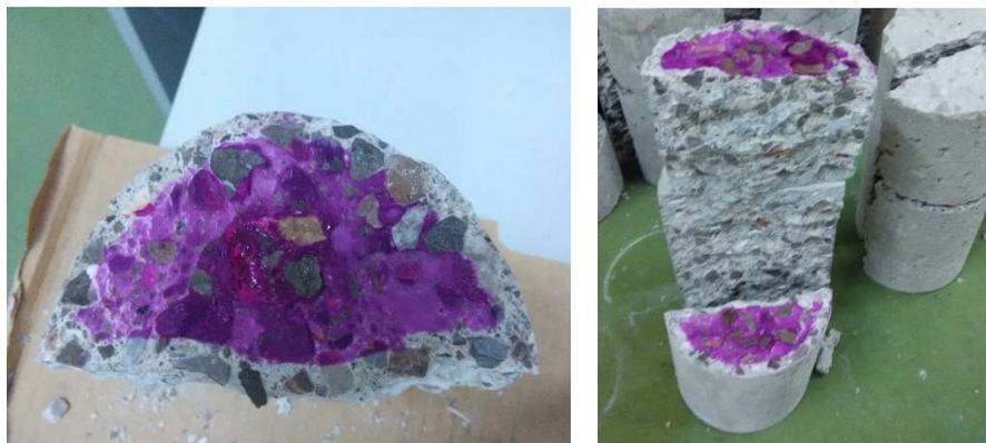
Figuras 29 y 30. Pulverizado de fenolftaleína sobre los cortes frescos del hormigón
