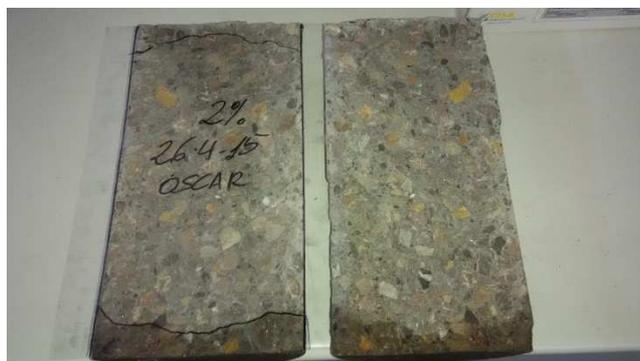
Figura 24. Probeta partida por su mitad para medir profundidad del agua
