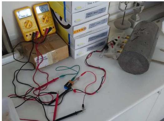
Figura 12. Ensayo de resistividad eléctrica, método Wenner
