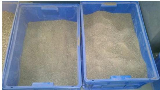
Figura 34. Acopio de árido desecado
