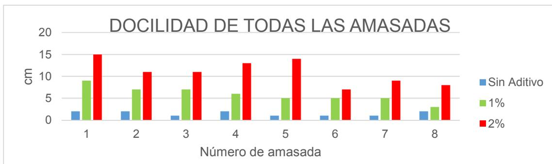
Gráfico 11. Resultado de asentamiento del hormigón en cm
