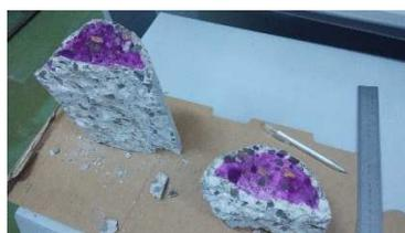
Figura 13. Ensayo de profundidad de frente de carbonatación
