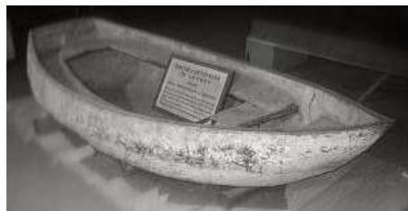
Figura 1. Bote de hormigón armado, construido por Joseph-Louis Lambot en 1848
