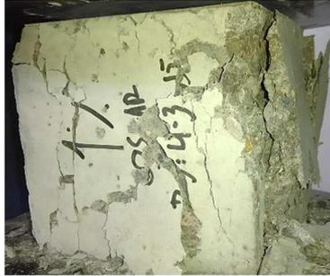
Figura 18. Probeta recién ensayada a compresión
