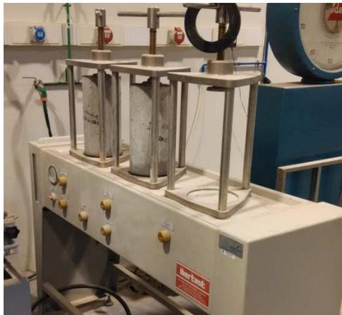
Figura 23. Probetas en máquina de penetración de agua bajo presión
