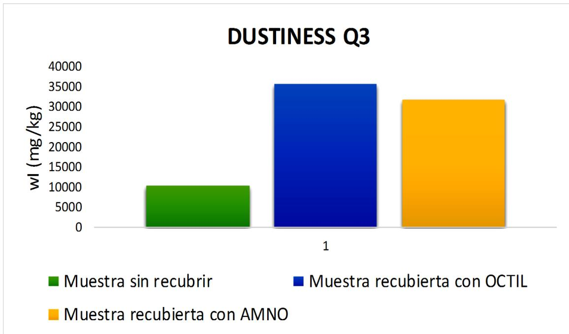
Finalmente, en la *figura 42* se muestra una gráfica en donde se puede observar el efecto en el dustiness al recubrir los cuarzos con silano en función del tamaño de partícula.
