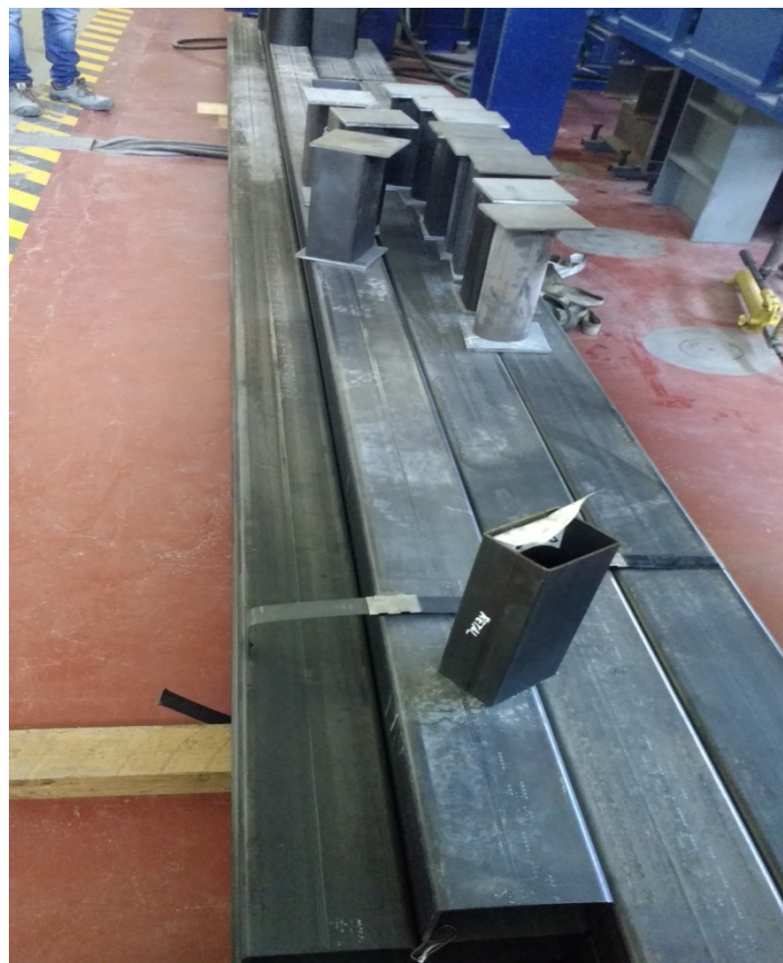
Ilustración 2. Tubos de 6 metros forma rectangular.
