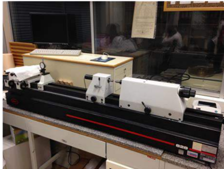
Figura 1: Mahr 828 antes de su reparación en el laboratorio acreditado.
