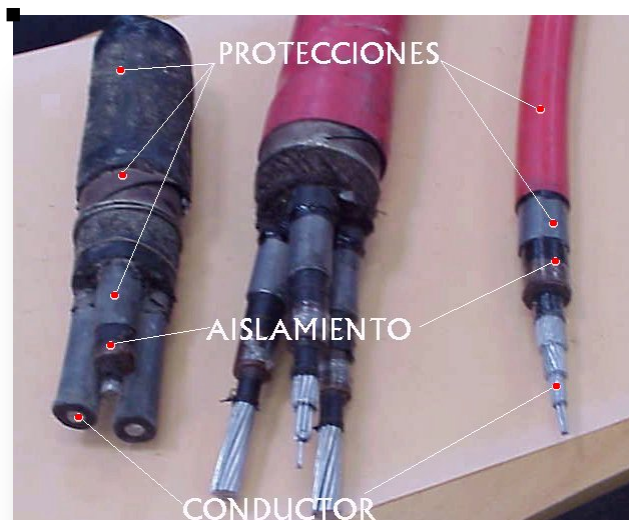
Figura 40. Componentes de un cable aislado
