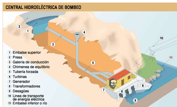
Figura 1.13. Esquema de una central hidroeléctrica de bombeo.
