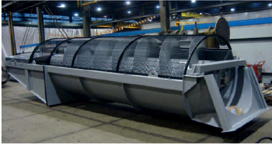
Figura 21. Canal de un tornillo.
