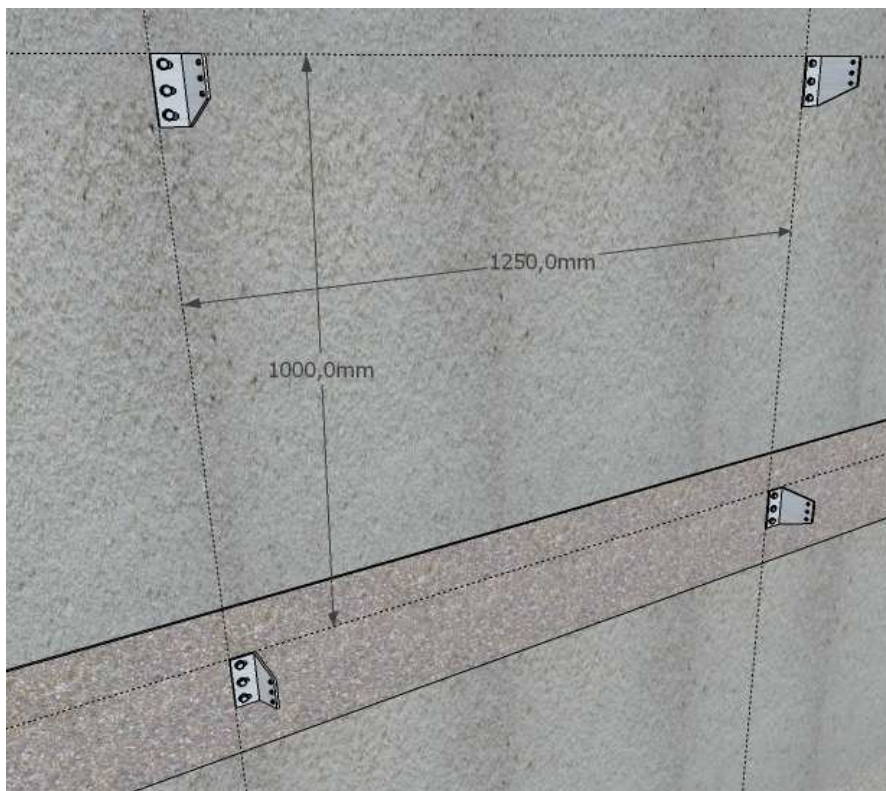
7.1. Imagen de replanteo de las ménsulas sobre el enfoscado de la hoja interior de fábrica.
