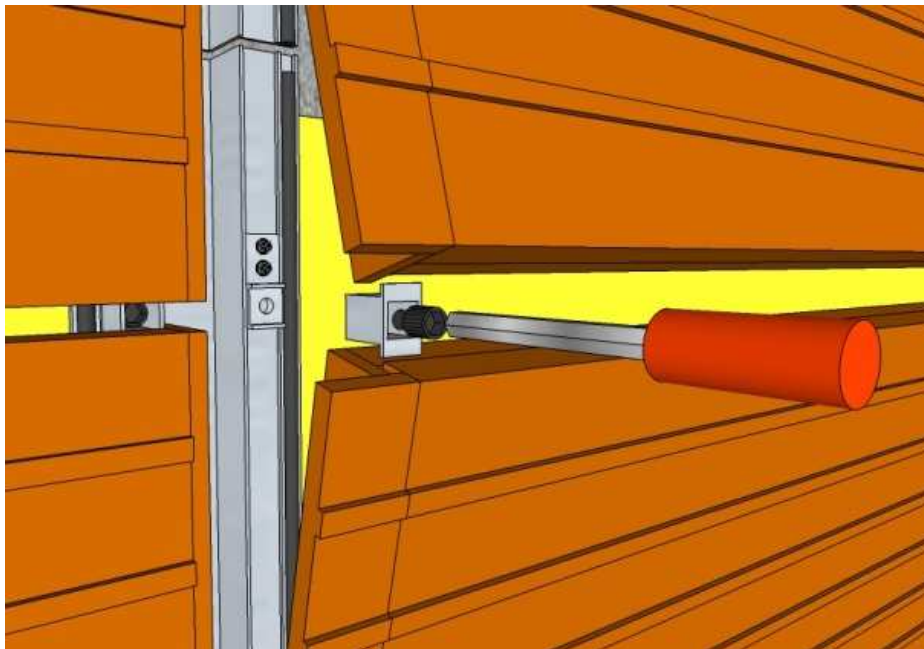
6.14. Las grapas de sujeción se han diseñado para que una intervención sea un proceso sencillo.
