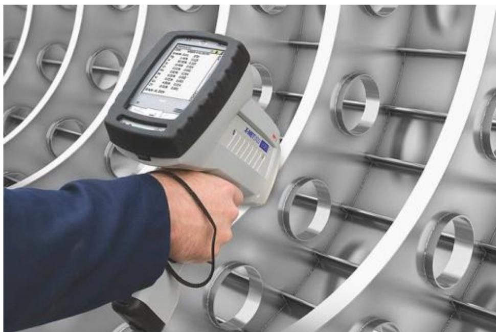
**Figura 3.** Pistola EDXRF para el control de calidad.
