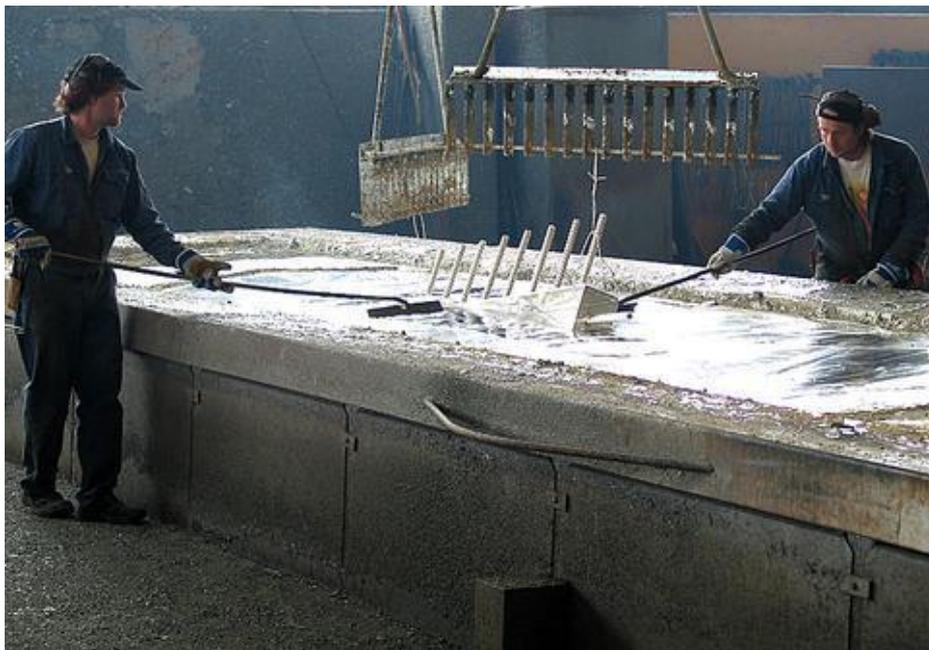
**Figura 1.** Baño de galvanizado en caliente.
