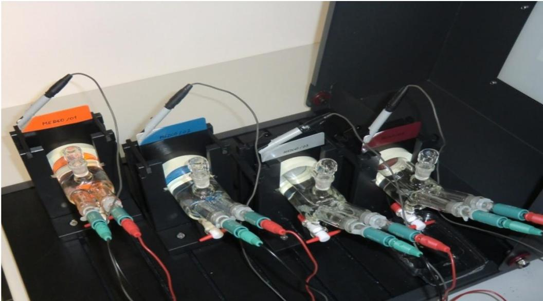
Figura 7. Módulo de medición incorporando las celdas y electrodos correspondientes.
