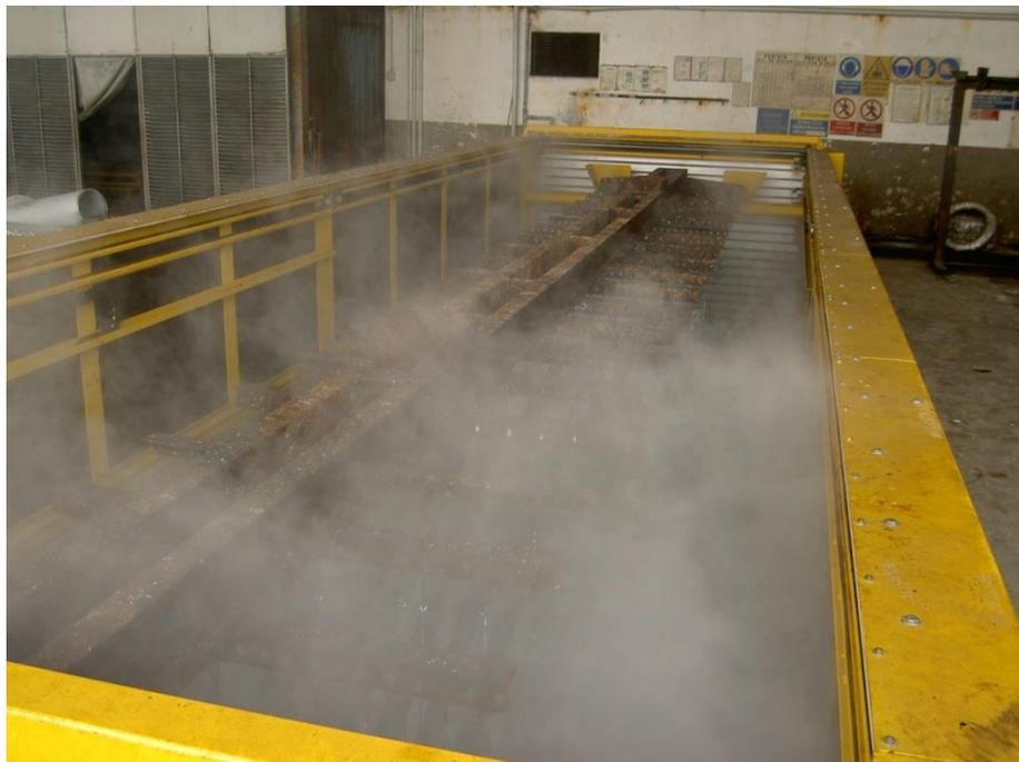
**Figura 2.** Sistema Soft-Rain para la aplicación de la conversión nanotecnológica en HDG.
